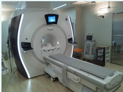
GE 社製『OptimaMR450W Expert』 磁場強度：1.5T 磁発生方式：液体 He 使用超電導方式
